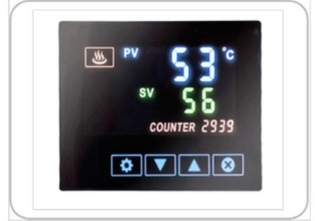
Esta prensa térmica también está equipada con un controlador LCD avanzado, súper preciso en control y lectura de temperatura. El usuario puede establecer la presión de aplicación mediante la configuración del controlador (modo P-4). El controlador también se presenta con función de espera de 120 minutos (modo P-5) ahorrando energía y ganando seguridad.
