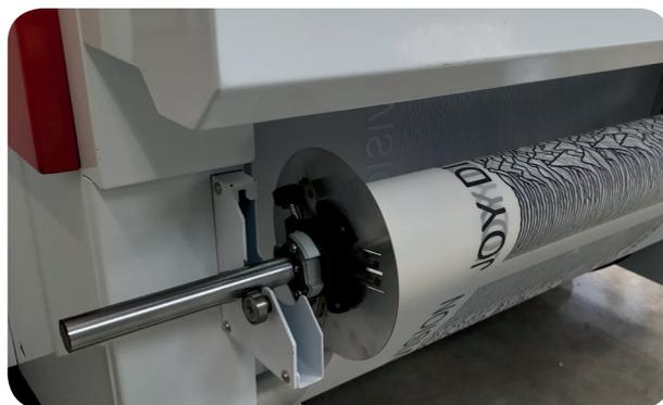
El sistema de recogida recogida de film con tensión le permite completar la producción sin supervisión para un flujo de trabajo continuo desde la impresión, alimentación y enrollado de forma segura.
