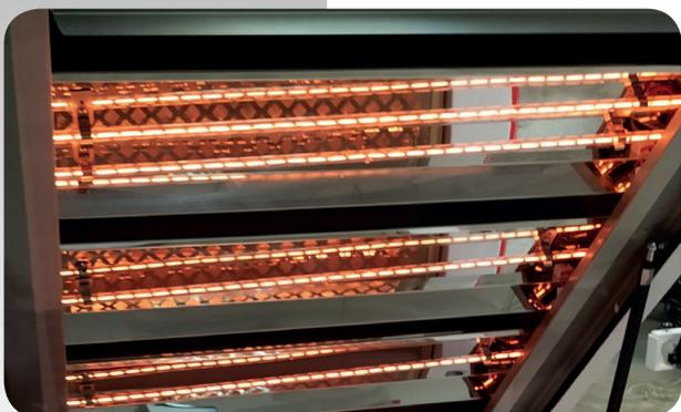
La temperatura ajustable por infrarrojos y el secado aplicado mejoran el curado de los polvos sobre el film.
