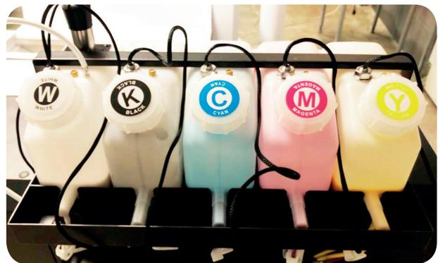
Equipado con un sistema bulk, que reduce la frecuencia de reposición de tinta.
