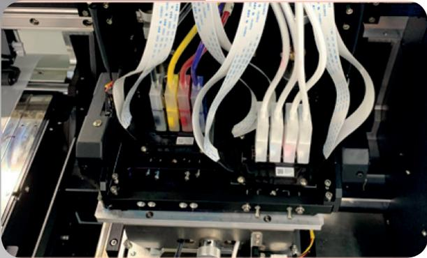
Cabezal de impresión Epson® PrecisionCore® para resultados de calidad industrial a velocidades de alta producción. Estable y de bajo mantenimiento.
