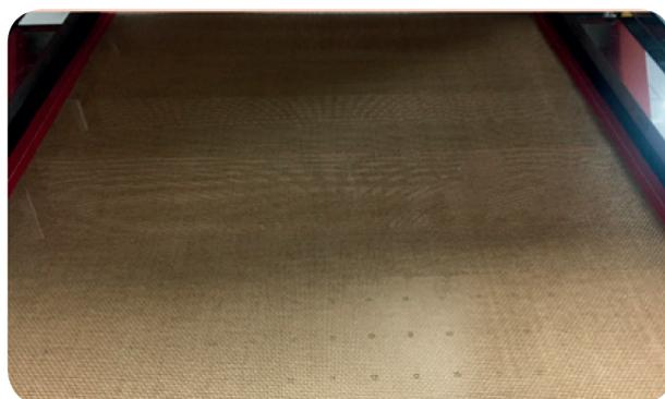
Cinta transportadora con sistema de succión por bomba de vacío, que asegura que el material en el horno no se mueva.
