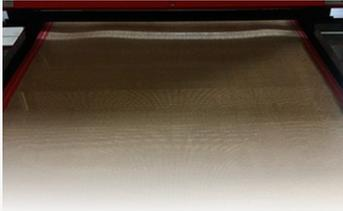
Horno con banda y absorción de vacío.
