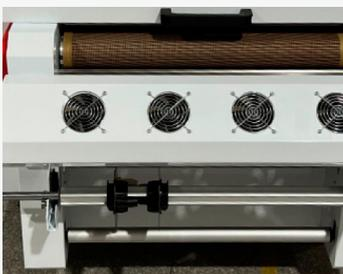
El sistema de alimentación y recogida de film con corrección de tensión le permite realizar la producción sin supervisión, para disfrutar de un trabajo autónomo y preciso.
